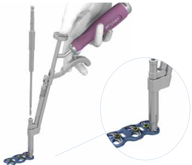
La guía de broca fija incluye un disparador que expande la punta de la guía en el orificio para el tornillo para localizar la trayectoria del tornillo de ángulo fijo.
